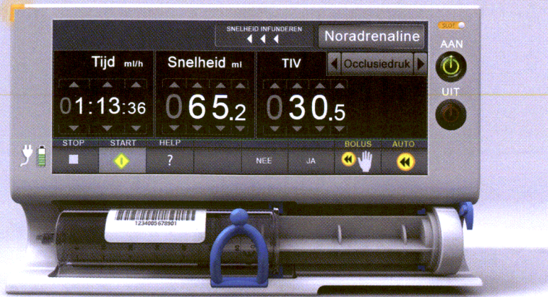
Een mogelijk ontwerp voor een nieuwe infuuspomp: het biedt een duidelijk overzicht van de hoofdfuncties en laat altijd de spuit met het medicijn zelf zien.
