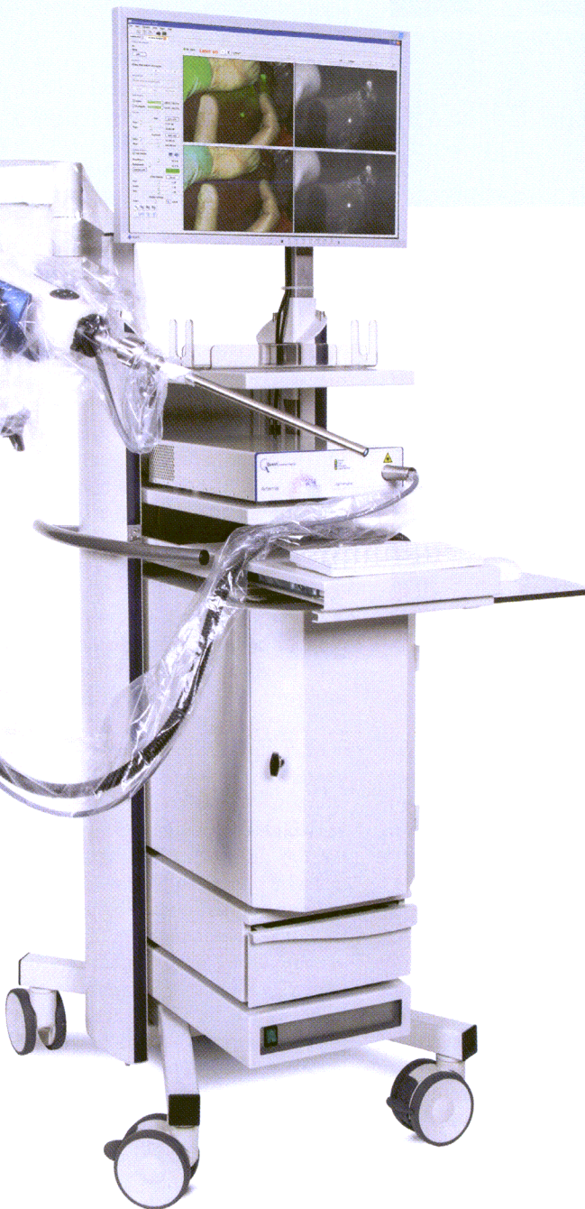
Het Artemis-systeem combineert een normaal kleurenbeeld met een of twee fluorescente kanalen.
