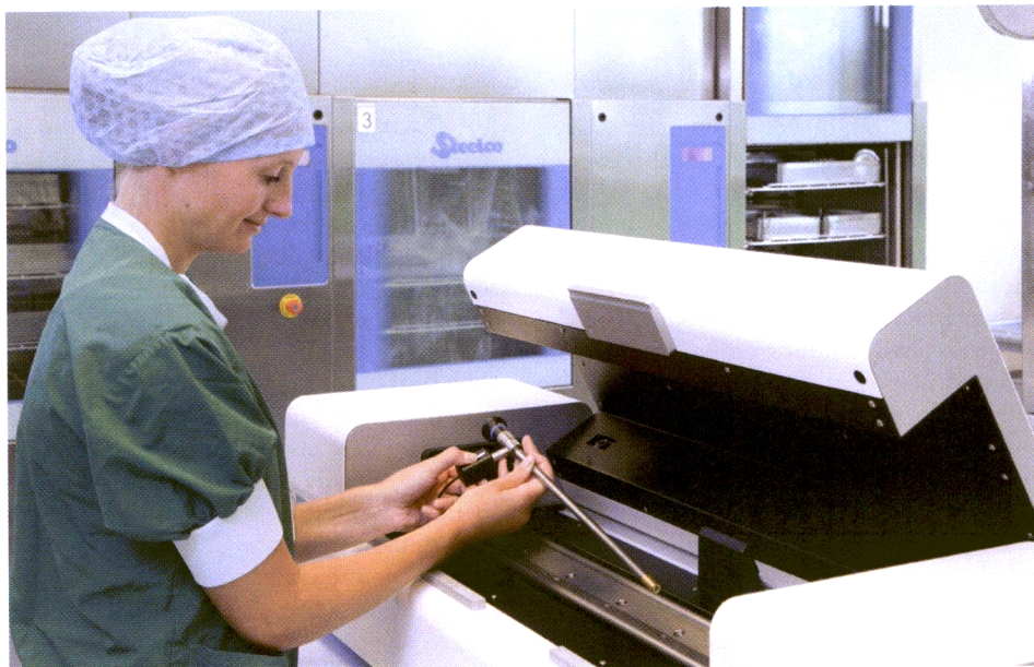
Met de endoscooptester van Dovidex kan de sterilisatieafdeling van een ziekenhuis het instrument binnen een minuut doormeten.
